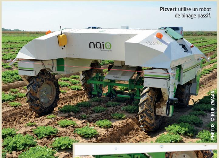
Picvert utilise un robot de binage passif.
