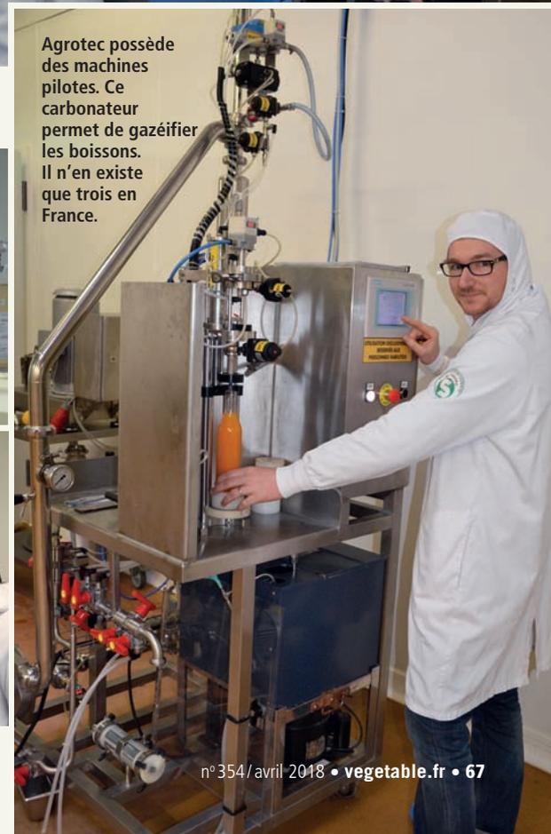
Agrotec possède des machines pilotes. Ce carbonateur permet de gazéifier les boissons. Il n'en existe que trois en France.
